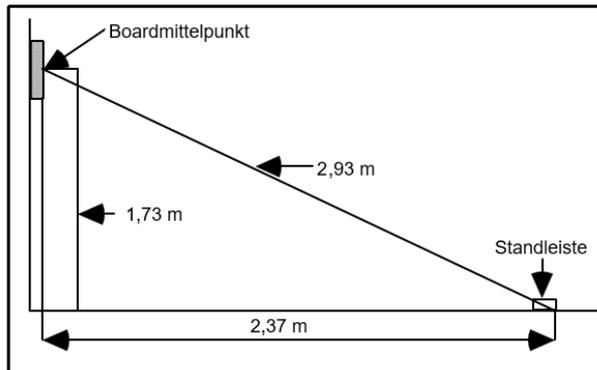
Abbildung 6: Maße Entfernung Bullseys bis Standleiste
